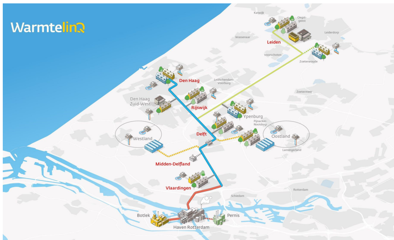
Figuur 7 - Schematische weergave warmtetransportsysteem Zuid-Holland. Bron: WarmtelinQ+
